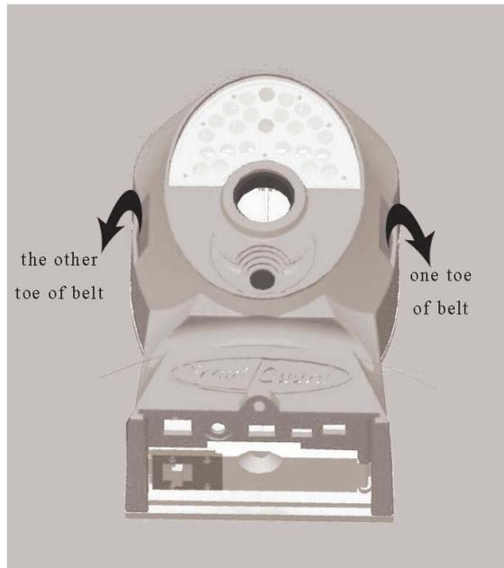
Fig. 17: Posición de la correa de fijación y el cable a la cámara
